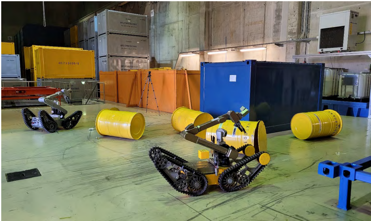
Abbildung 3-8: Lokalisieren und Bergen der Quellen mittels Fernhantierungstechnik
