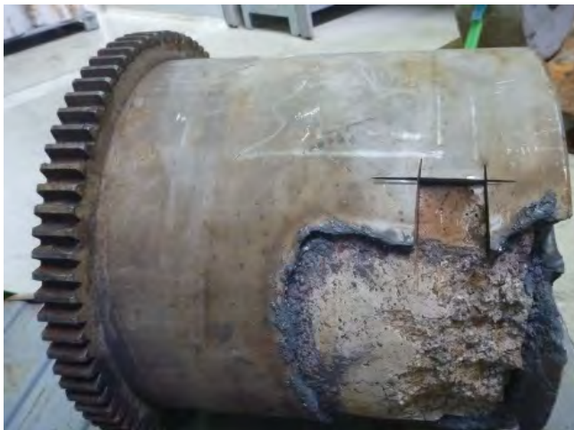
Abbildung 3-5: Strahlrohrverschluss nach Bearbeitung und Probenahme
