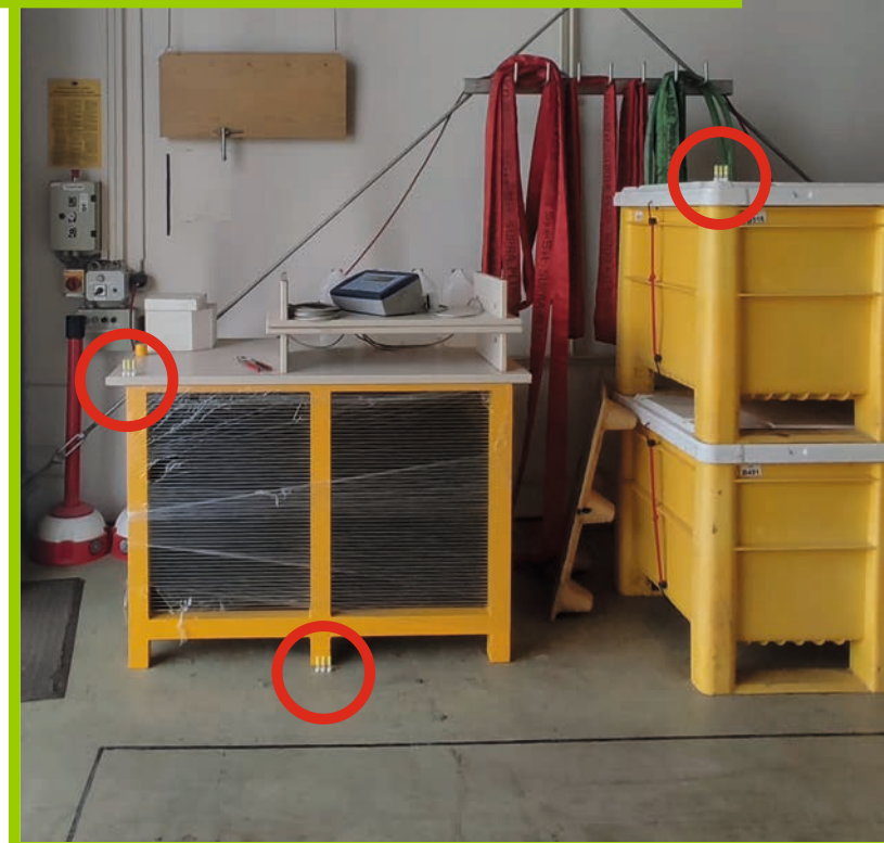
Messszenario mit drei verschiedenen Co-60 Quellen mit einer Aktivität von je 1,5 MBq bei einem Abstand von 2,8 m
